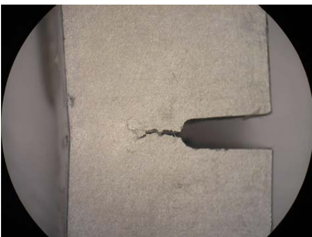
Figuur 1. Voorbeeld van scheurvorming bij een metalen onderdeel
