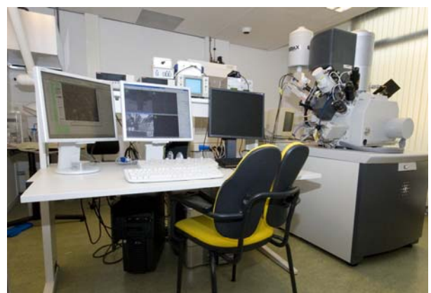
Figuur 3. Voorbeeld van elektronenmicroscop die wordt gebruikt voor divers schadeonderzoek.
