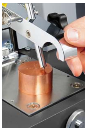
Figuur 1. Meten van een koper legering met behulp van Optische Emissie Spectroscopie.
