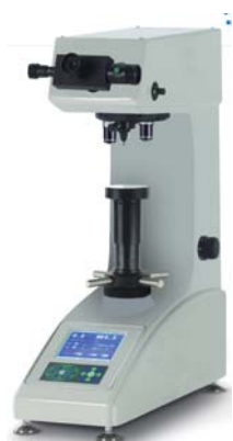
Figuur 1. (a) Vickers hardheidstester; (b) Vickers hardheidmeting.
